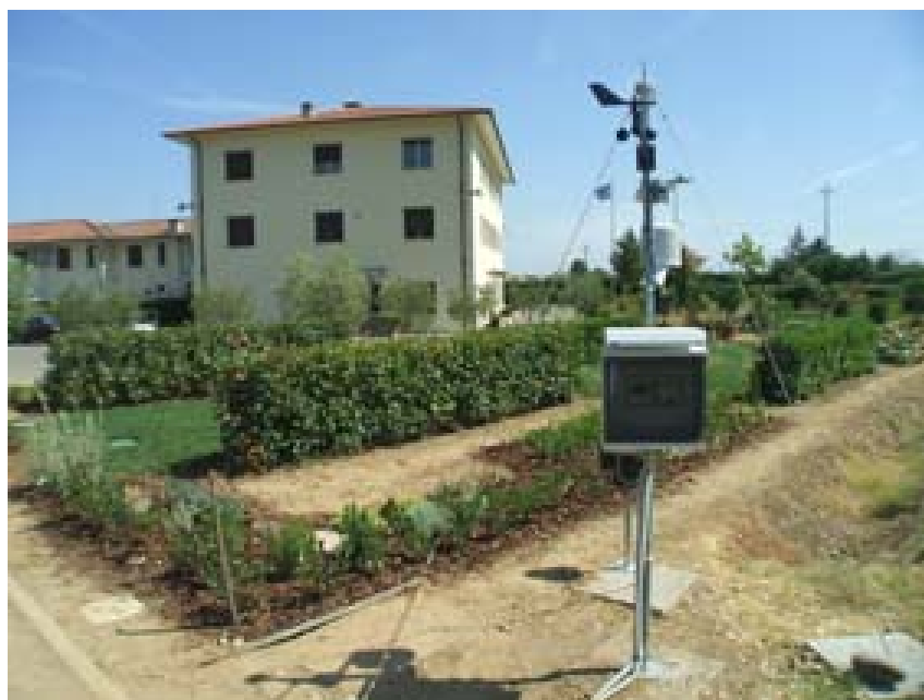
Fig. 2 - Area dei due giardini sperimentali presso il CRA- Viv di Pescia: in primo piano la Stazione di riferimento della rete di monitoraggio, comprendente anche il sistema di gestione automatica dell'irrigazione e di controllo remoto mediante modem GSM/GPRS.
