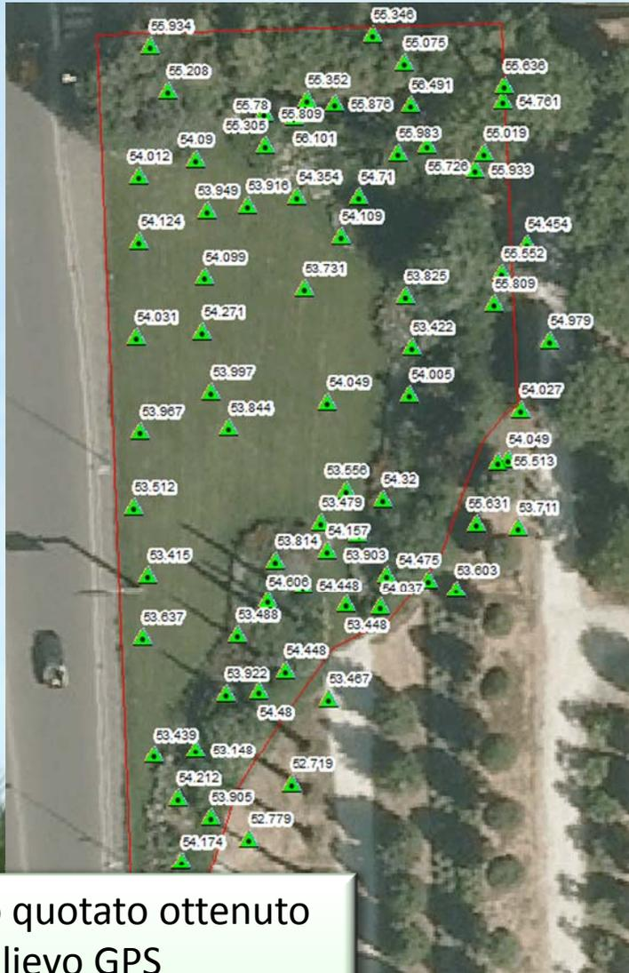
Piano quotato ottenuto con rilievo GPS (Piante Mati - Pistoia)
